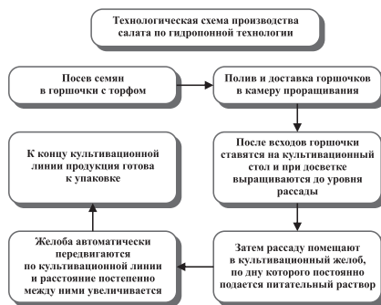
Рис. 2 – Технологическая схема выращивания салата листового по гидропонной технологии
