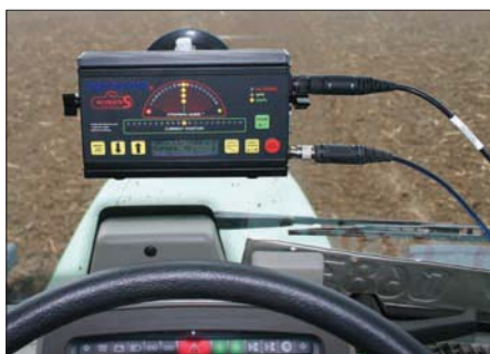
Внешний блок GPS фирмы «Агроком» (Agrosom) установлен на воздушных присосках на переднем стекле кабины трактора.
