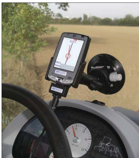
КПК служит в качестве прибора-индикатора, показывающего отклонение машины от заданного маршрута (Isagri).
