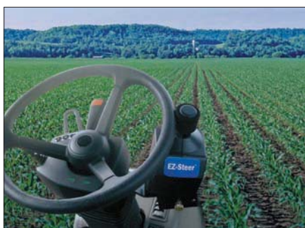
Серводвигатель устройства EZ-steer установлен на рулевом колесе и автоматически удерживает трактор на заданном маршруте.
