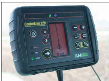
Прибор LH Agro Centerline 220 показывает заданную траекторию и количество находящихся на связи спутников DGPS (слева).
